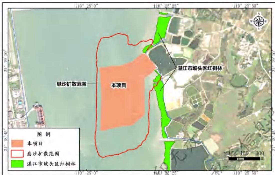
图 6.2.2-1 项目悬沙扩散与“三区三线”中生态保护红线位置关系示意图
